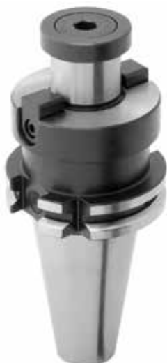
Mandrino portafrese fisso con passaggio refrigerante , DIN 69871 ISO40, forma ad+b. Mandrino con bilanciatura standard G 6,3 / 12.000 rpm.
