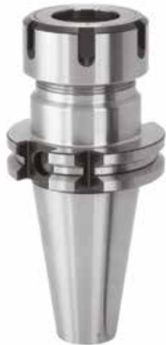
Mandrino portapinze , con ghiera standard, DIN 69871 ISO40, forma ad+b. Mandrino con bilanciatura standard G 6,3 / 12.000 rpm.
