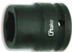
5035 1 ME Chiave a bussola macchina con bocca esagonale, attacco 1" , acciaio speciale al cromo molibdeno, esecuzione fosfatata.
