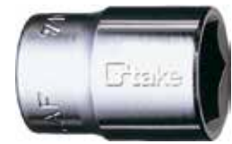
5035 1/2 E Chiave a bussola con bocca esagonale, attacco 1/2" , acciaio speciale al cromo vanadio, esecuzione cromata.
