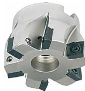
Fresa per spallamenti retti 89,50° TA9409 , con fori di refrigerazione, 4 taglienti utili, inserto altezza 9mm.
